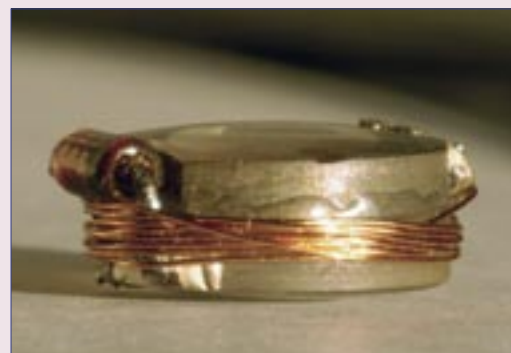
De besturing van de lens in deze proefopstelling bestaat uit een zender met een spoelantenne (licht gekleurde rol) en een spoelontvanger (binnenin de grote spoel) die direct met de lens is verbonden.
